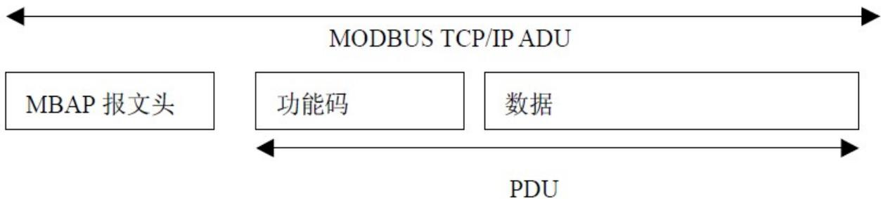
图 6: TCP/IP 上的 MODBUS 的请求/响应
